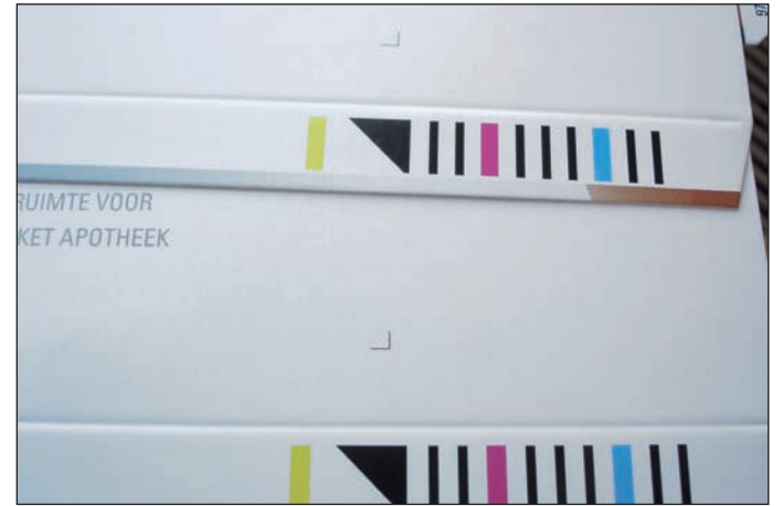
De kleurcode geeft een verpakking een uniek ID-nummer dat wordt gecontroleerd door apparatuur van Nordson.
